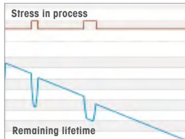
Die ISM-Technologie ermöglicht vorausschauende Wartung und unterbindet außerplanmäßige Betriebsunterbrechungen. Moderne Sensordiagnosewerkzeuge stehen über FOUNDATION Fieldbus, PROFIBUS PA, HART oder den zweiten Analogausgang am Transmitter zur Verfügung.
