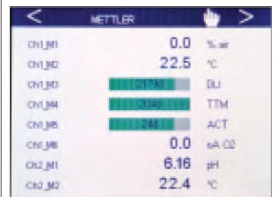
Eine konfigurierbare Anzeige ermöglicht höchste Flexibilität bei der Wiedergabe der wichtigsten Werte. Das Setup per Assistent ermöglicht die Definition von Favoriten, um direkt ein bestimmtes Menü erreichen zu können.
