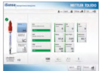
Mit iSense™, dem wichtigsten Instrument von ISM, können die Sensoren über einen PC vorkalibriert und dann mit dem M100 verbunden werden. Eine Benutzerschnittstelle am Einsatzort ist daher nicht mehr erforderlich. Das neue Transmitterkonzept reduziert den Betriebs- und Verdrahtungsaufwand auf ein Minimum.
