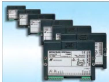
Die Zweikanalmessung senkt die Kosten pro Messstelle, etwa in Fermentationsprozessen (pH/gel. Sauerstoff) oder erlaubt redundante Messungen (pH/pH) in chemischen Prozessen.
