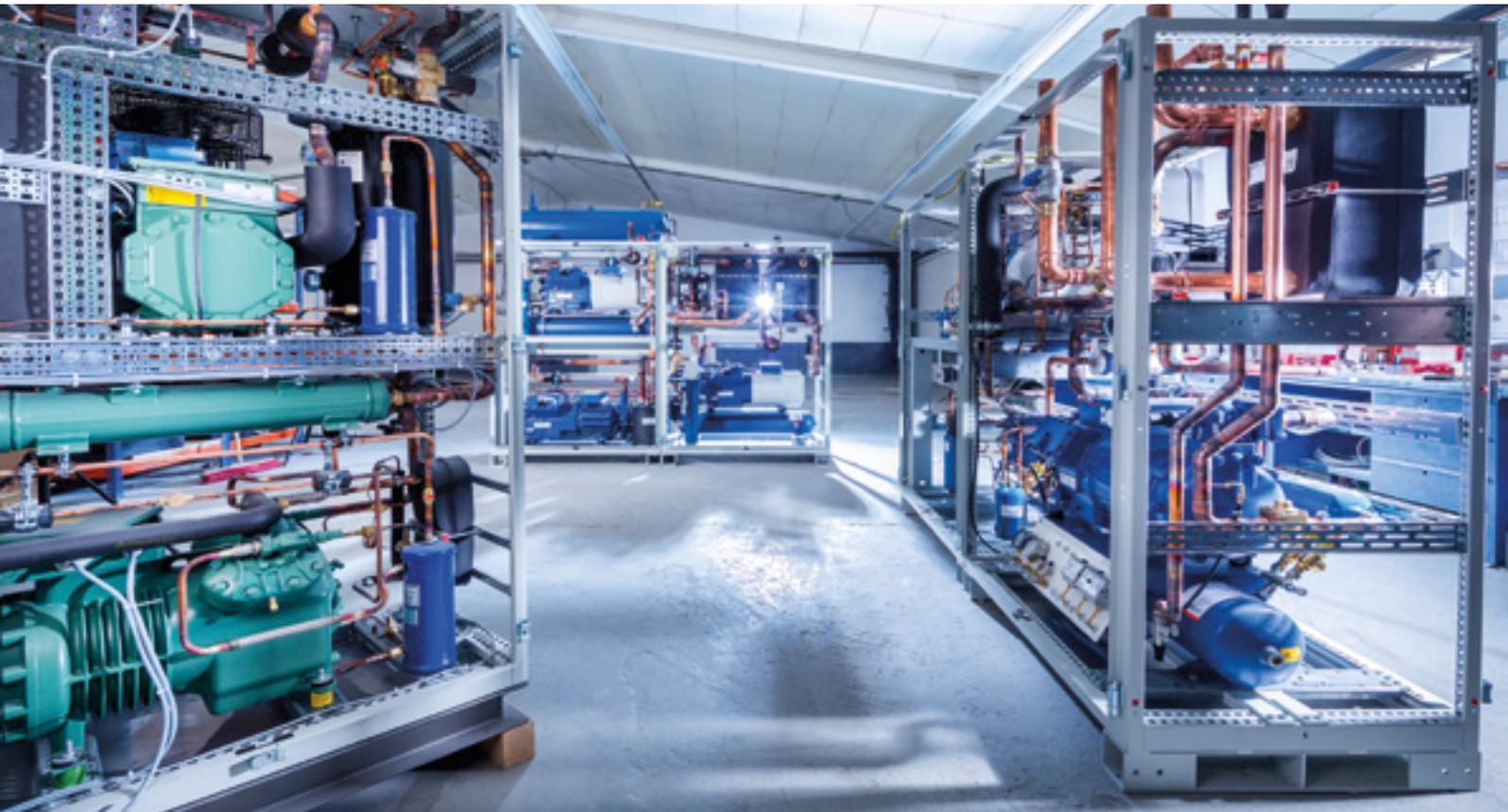
Sonderkältemaschinen mit Tiefsttemperaturen bis  $-120$  Grad.
