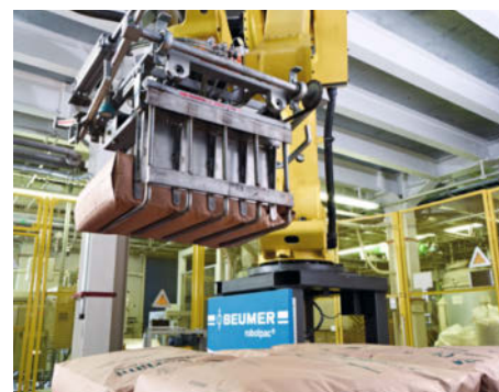
Gabelgreifer greift und stapelt hochwertiges, abgefülltes Amidwachspulver
